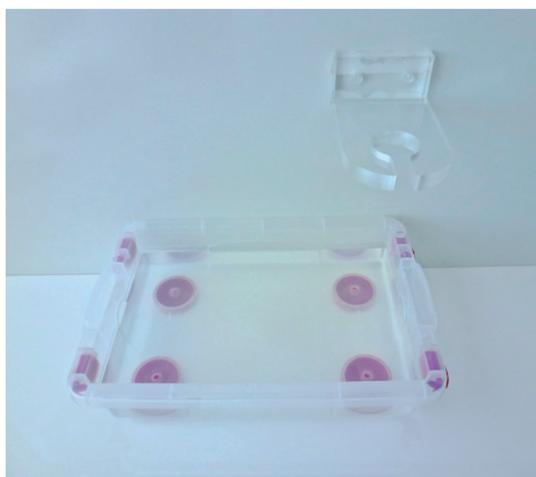
O suporte para ótica flexível com caixa plástica contendo solução para imersão.
