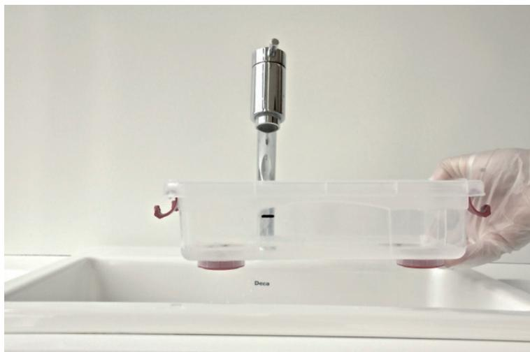
Figura 3. A linha preta marcada na caixa, dá o nível da água filtrada para diluição ideal.
